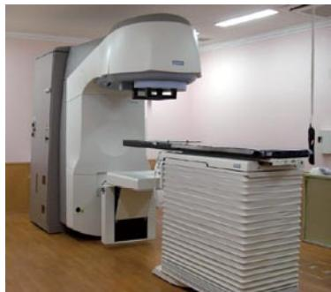
5月に放射線治療装置(リニアック)新機種を導入しました。新機種は、ONCOR impression plus : SIEMENS社製です。放射線療法は、手術による外科療法、抗がん剤による化学療法と並ぶがん治療の3本柱のひとつで、放射線の細胞分裂を止める作用により腫瘍を縮小させます。当院の放射線療法は、体の外から放射線を照射する外照射にて治療を行います。使用可能なエネルギーは、X線 6MV、10MV、電子線 6～21MeVで、病変によって使い分けて治療を行います。新機種では、イメージガイド放射線治療(IGRT)が可能になり、正面、側面の写真を撮影することにより、治療計画時の体位とずれが無いかを確認することができ、ずれがある場合は、位置補正をしてから放射線治療を行うことになります。また当機種は、治療用のMegavoltageビームを利用して、3D撮影が可能であり、より高精度の正確なポジションの検証と調整を行うことが出来ます。
